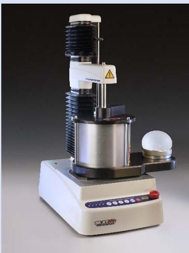
用於麵團的吹泡測試，一般粉質檢測後進行吹泡，可測試麵團的韌性、延展性、破裂強度，P、L、W 值等綜合的烘焙力評價。樣品的處理過程簡便，這個成熟的系統可應用於研發、品控和產品生產監控的全面綜合的測試工具。可自動顯示結果及根據給定值進行計算
