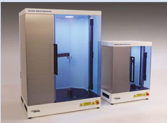
完成全部檢測後，會馬上對麵包體積、長度、最大寬度、最大高度、最大寬度的高度以及最大高度的寬度的測量結果保存歸檔。然後，它會自動計算出生產出麵包的體積。該資料可通過二維視圖或三維視圖進行查看，從而可與此前保存的測量結果進行視覺比較。整個
