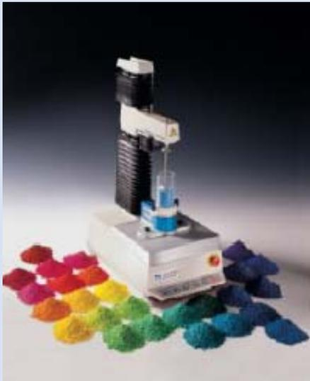
能夠測量所有具有流動和移動性能的樣品而不僅僅是容易自由流動的粉體。快速、自動的測試和分析，執行 Go-No Go 的判斷程式，作為品控應用。樣品在預處理前進行測試，可區隔出各種不同粉體的特性。每次依據精確的重複測試程式來獲取測試樣品所需要的最佳條件。運用程式設計好的測試程式可以通過切 (slicing)、剪 (shearing)、壓縮 (compressing)、擠壓 (compacting)、混合 (Mixing)、提升 (lifting) 以及以上綜合方式處理樣品。
